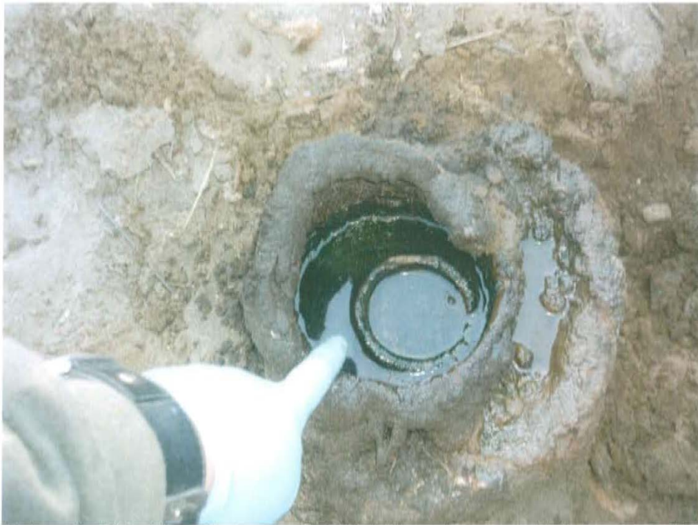
Fotografía N° 3. Afloramiento superficial de hidrocarburos mezclado con agua del interior del Pozo T4689.
