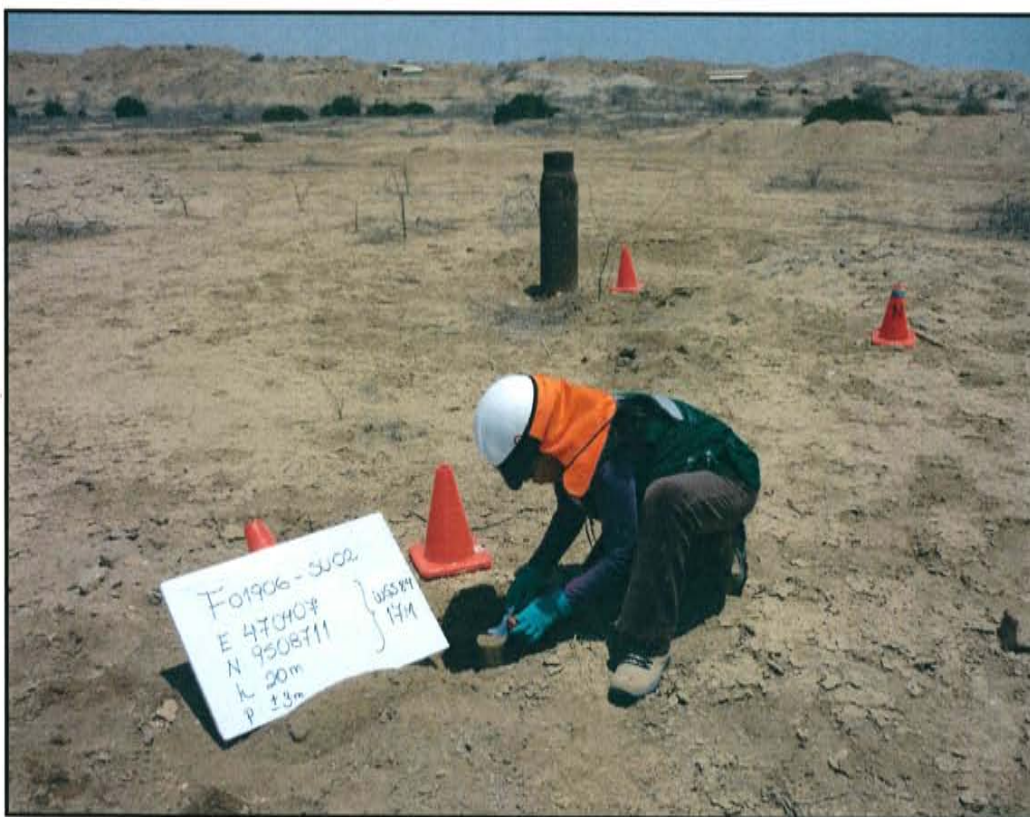
Fotografía N° 3. Toma de muestra de suelo en el punto F01906-SU02, ubicado a 4,9 m aproximadamente del Pozo L_361.
