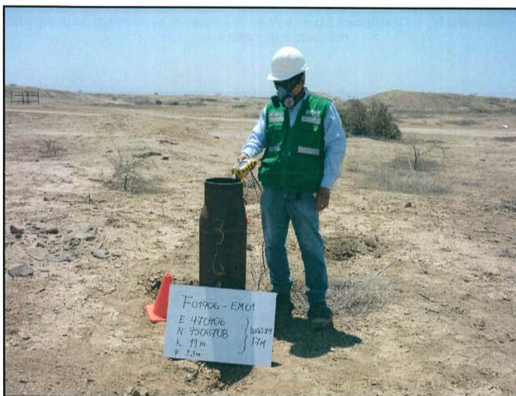
Fotografía N° 4. Medición de emisiones fugitivas en boca de Pozo L_361.
