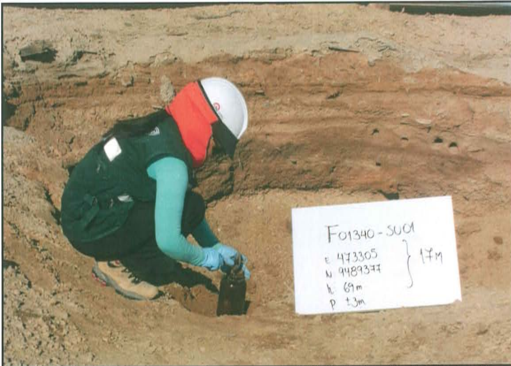
Fotografía N° 3. Toma de muestra en el punto F01340-SU01, ubicado a 2,5 m de distancia del casing del pozo T 2684 a una profundidad de 0,2 m de la superficie del suelo.
