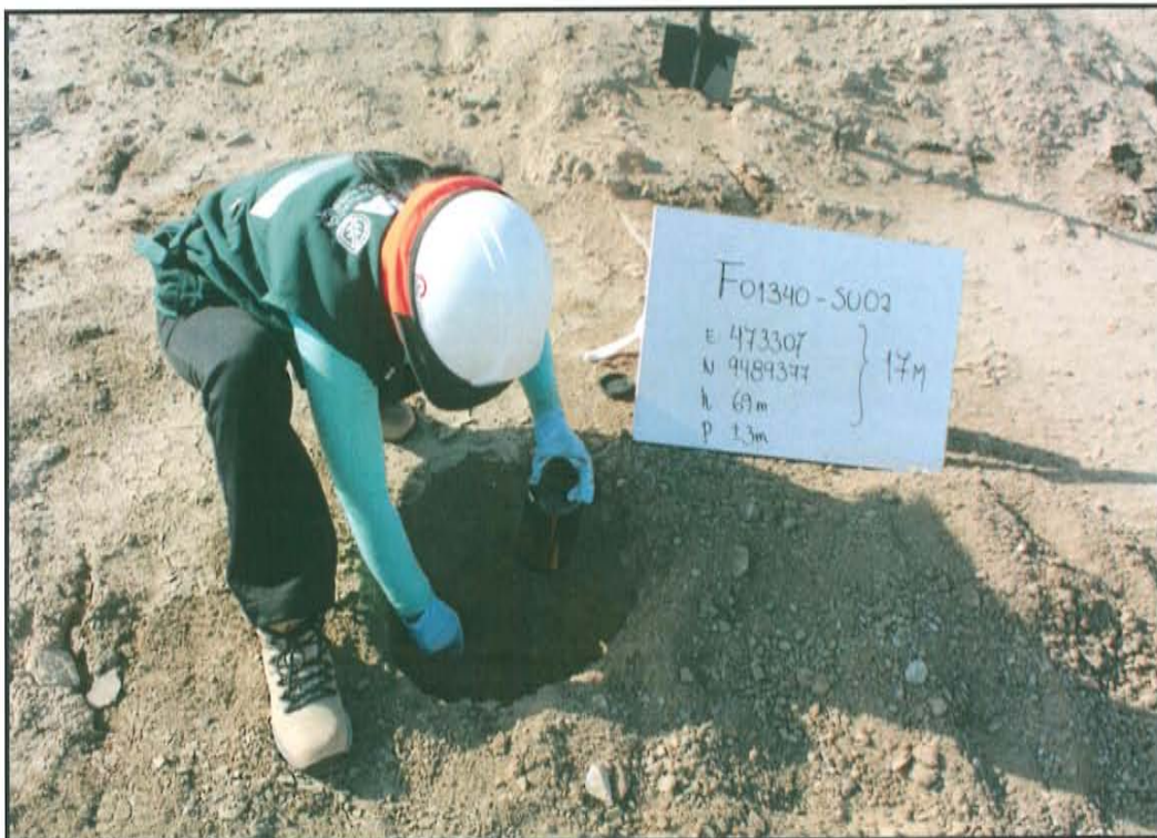
Fotografía N° 4. Toma de muestra en el punto F01340-SU02, ubicado a 6 m de distancia del casing del pozo T 2684 a una profundidad de 0,35 m de la superficie del suelo.
