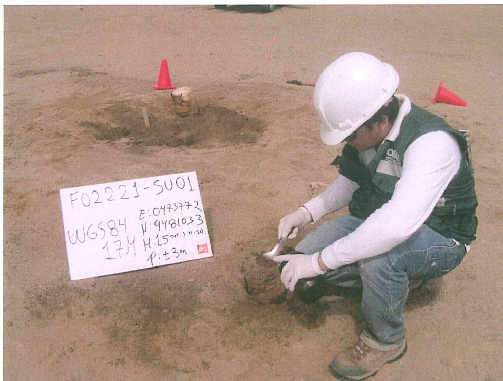
Fotografía N° 3. Toma de muestra de suelo en el punto F02221-SU01, ubicado a 2 m aproximadamente del Pozo T7656.
