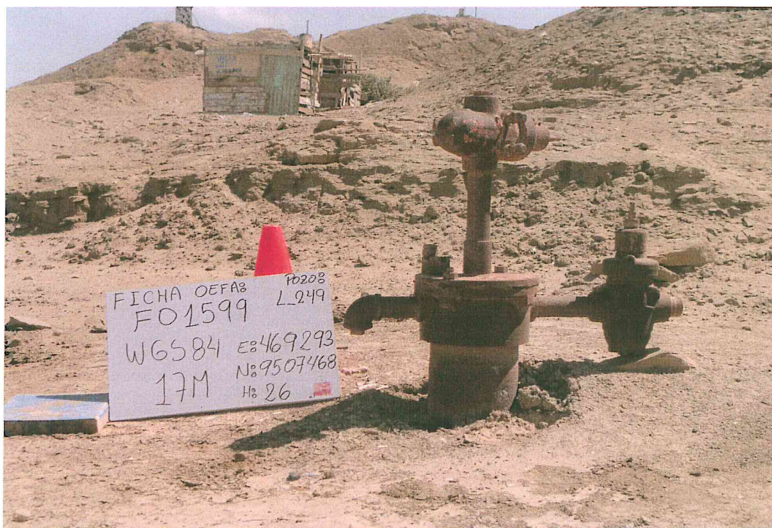
Fotografía N° 1. Pozo inactivo en terreno no habilitado sin acceso vial directo, se observa cabezal del pozo compuesto por una brida, dos salidas laterales y tubo reducción.
