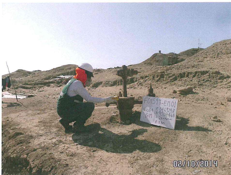
Fotografía N° 3. Medición de emisiones fugitivas en boca de Pozo L_249.
