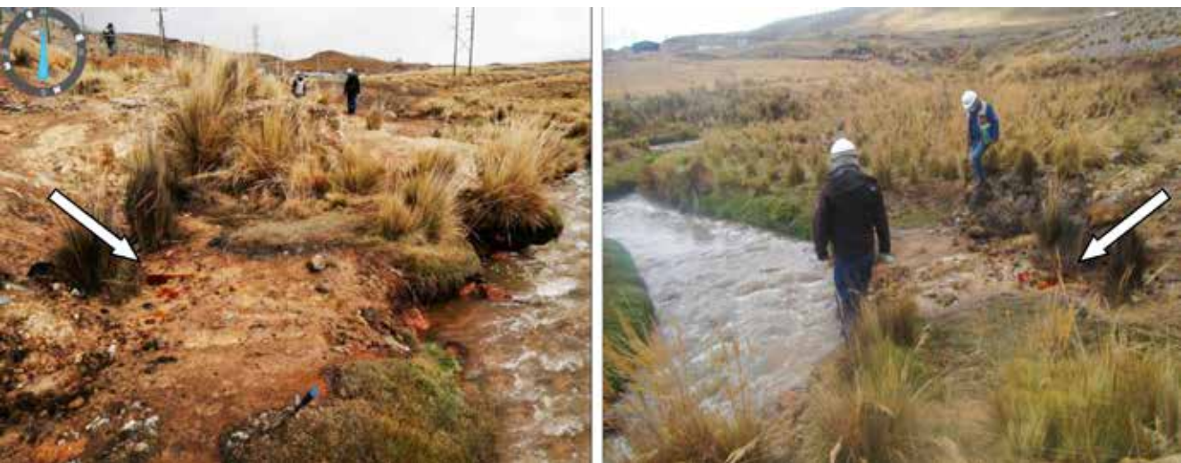
Figura 17. Ejemplo de filtraciones dispersas registradas en el borde del río Ragra
