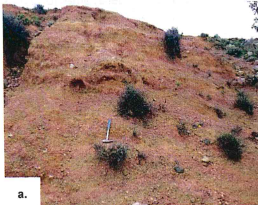
Figura 8- 27. Vista de a. erosión de suelos compuesto por arcillas b. carcavamiento en el área donde se emplazará el PAD de lixiviación
