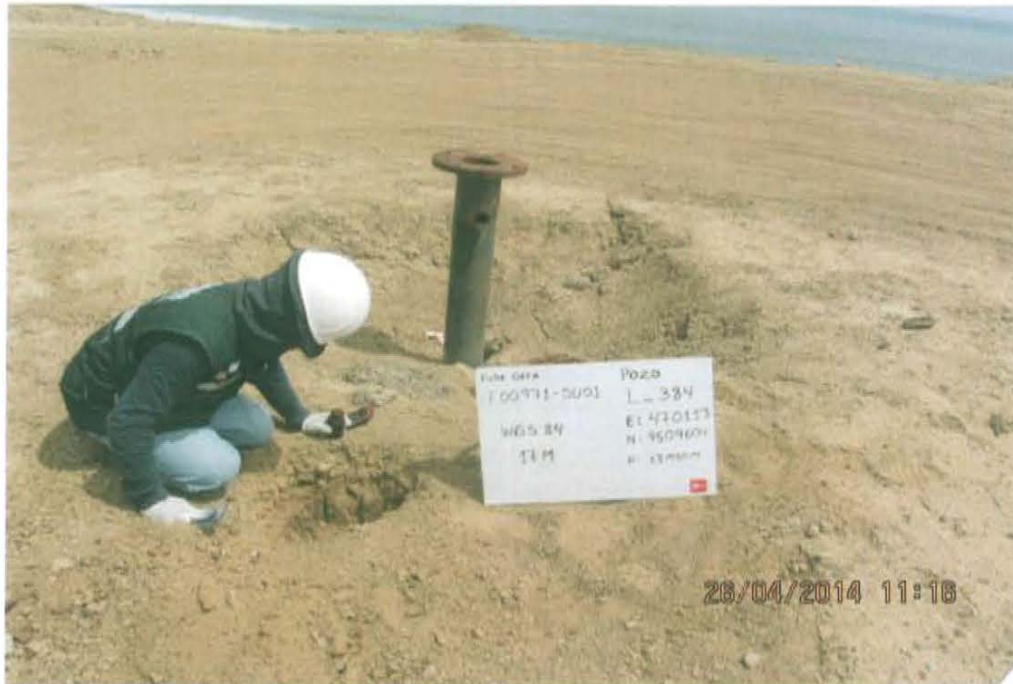
Fotografía N° 3. Toma de muestra de suelo en el punto F00971-SU01, ubicado a 2 m de distancia del casing del Pozo L_384.
