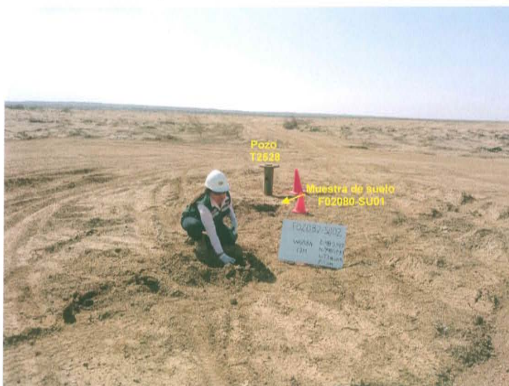
Fotografía N° 4. Toma de muestra de suelo en el punto F02082-SU02, ubicado a 4 m aproximadamente del Pozo T2528.
