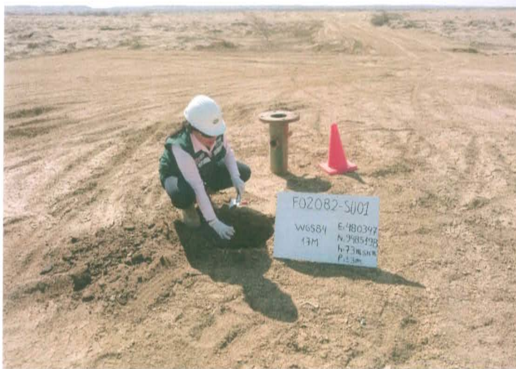
Fotografía N° 3. Toma de muestra de suelo en el punto F02082-SU01, ubicado a 2 m aproximadamente del Pozo T2528.
