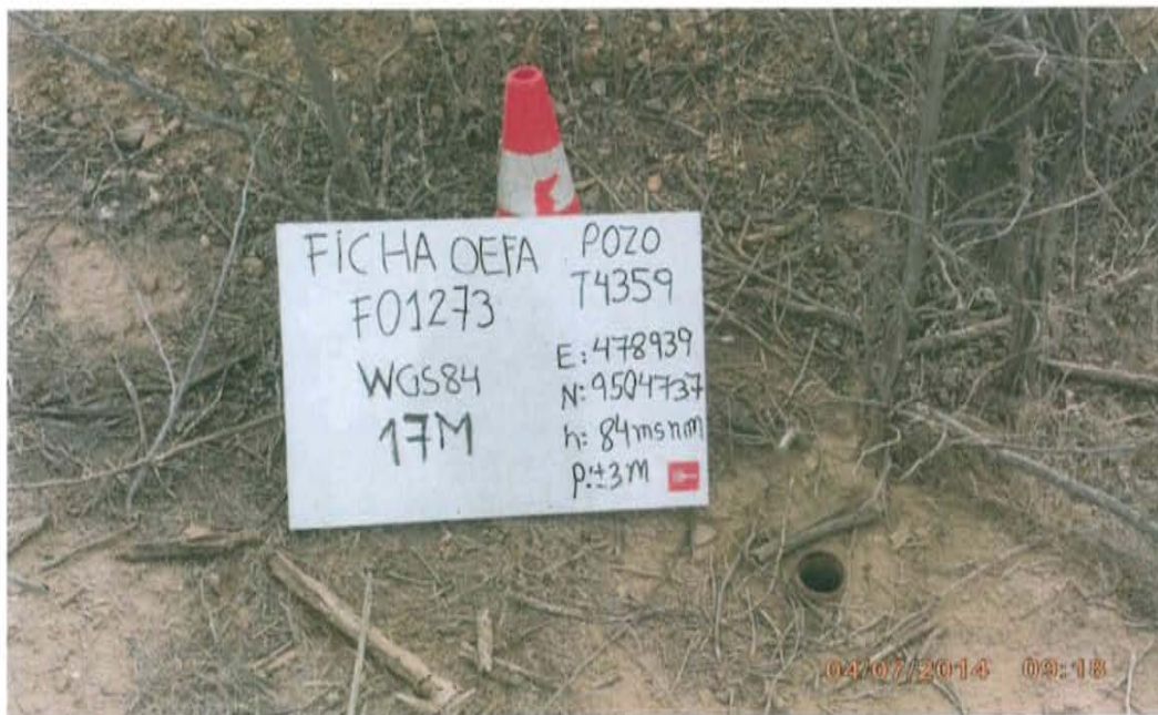
Fotografía N° 2. Vista del pozo, el casing de 2,5 " de diametro, sobresale 0,10 m de la superficie del suelo. No se observa afloramiento de líquidos ni se perciben olores característicos a hidrocarburos, asimismo no se observa suelo impregnado con hidrocarburo y/o residuos industriales alrededor del pozo.
