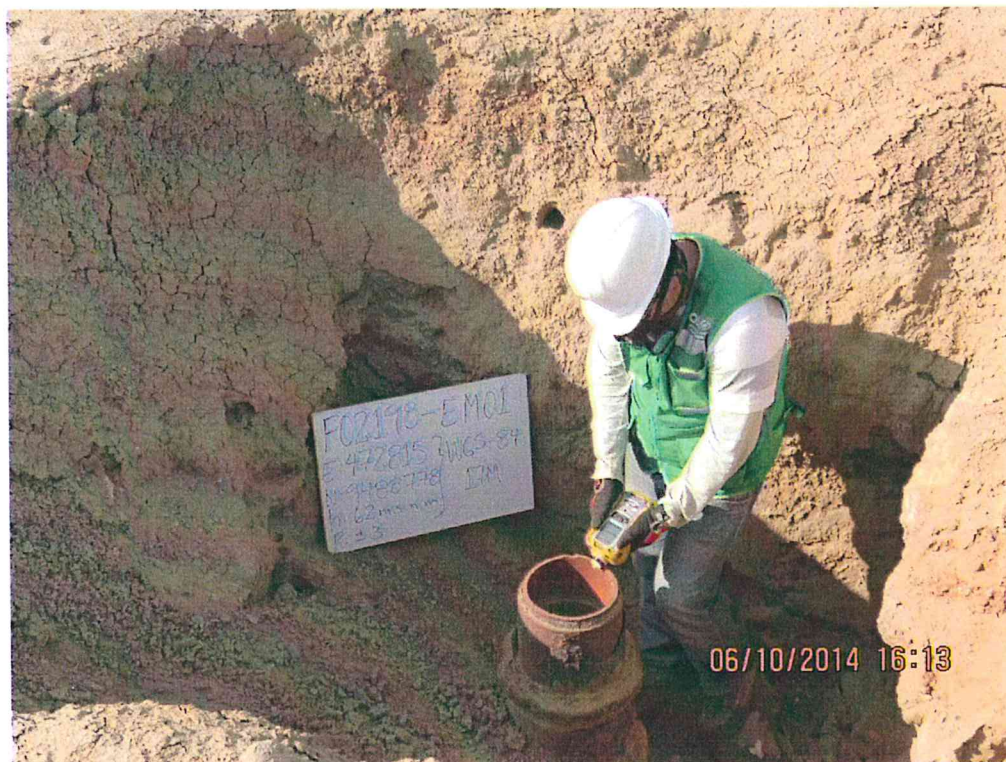
Fotografía N° 4. Vista de la medición de emisiones con código F02198-EM01, ubicado en boca de pozo.
