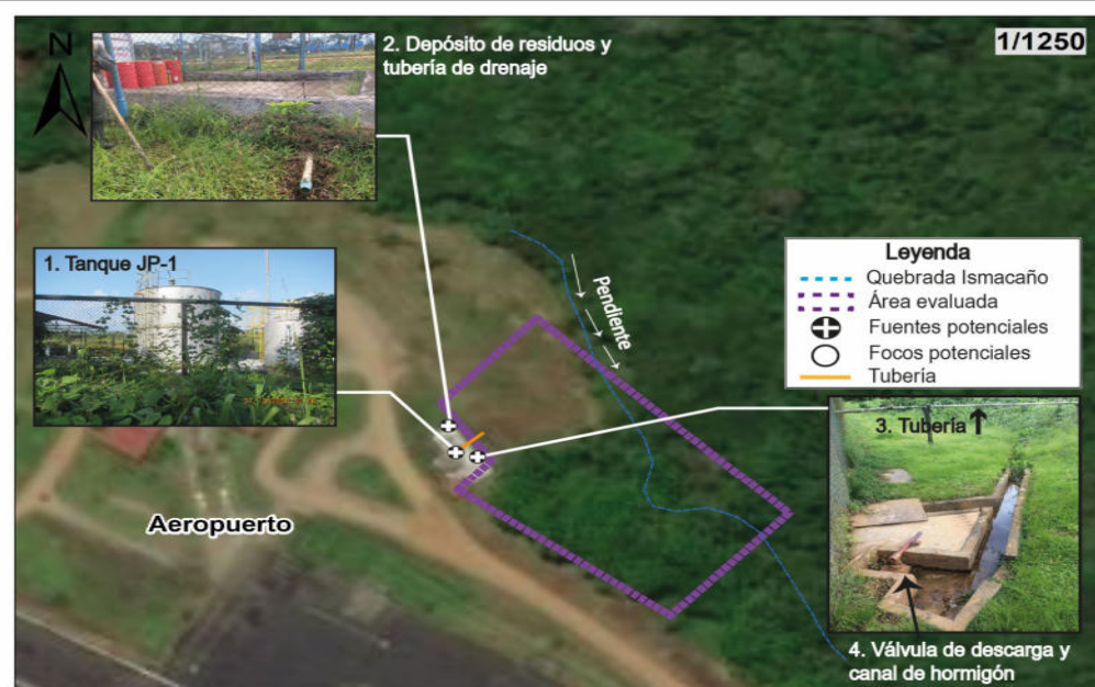
Figura que muestra las fuentes primarias potenciales de contaminación en el sitio S0142.
