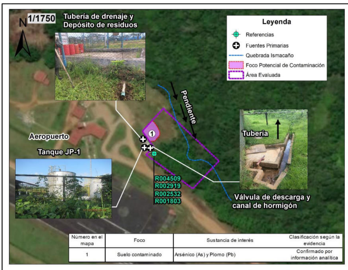
Figura 8.10. Ubicación de fuentes y foco de contaminación S0142
