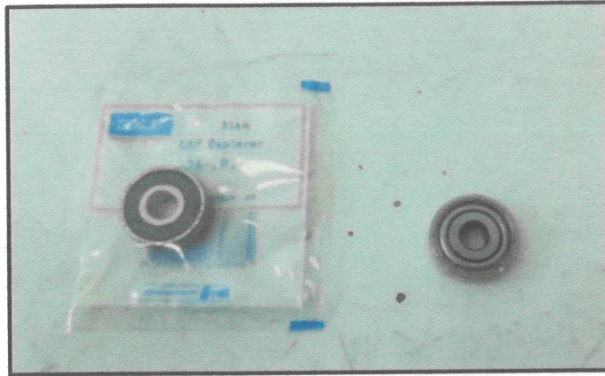
Fig. 02.- Se cambió el rodamiento y soportes para bomba de succión.
