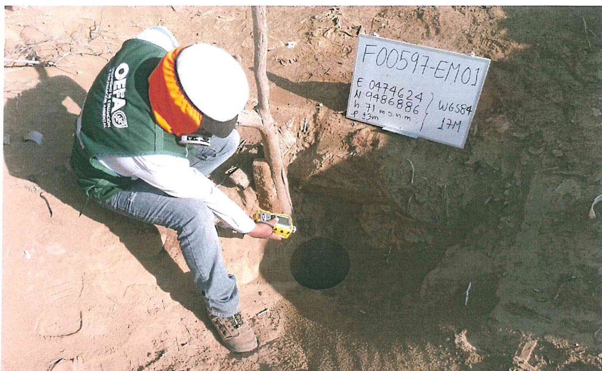
Fotografía N° 5. Medición en el punto F00597-EM01, ubicado en la fuente de emisión en boca del pozo T2833.
