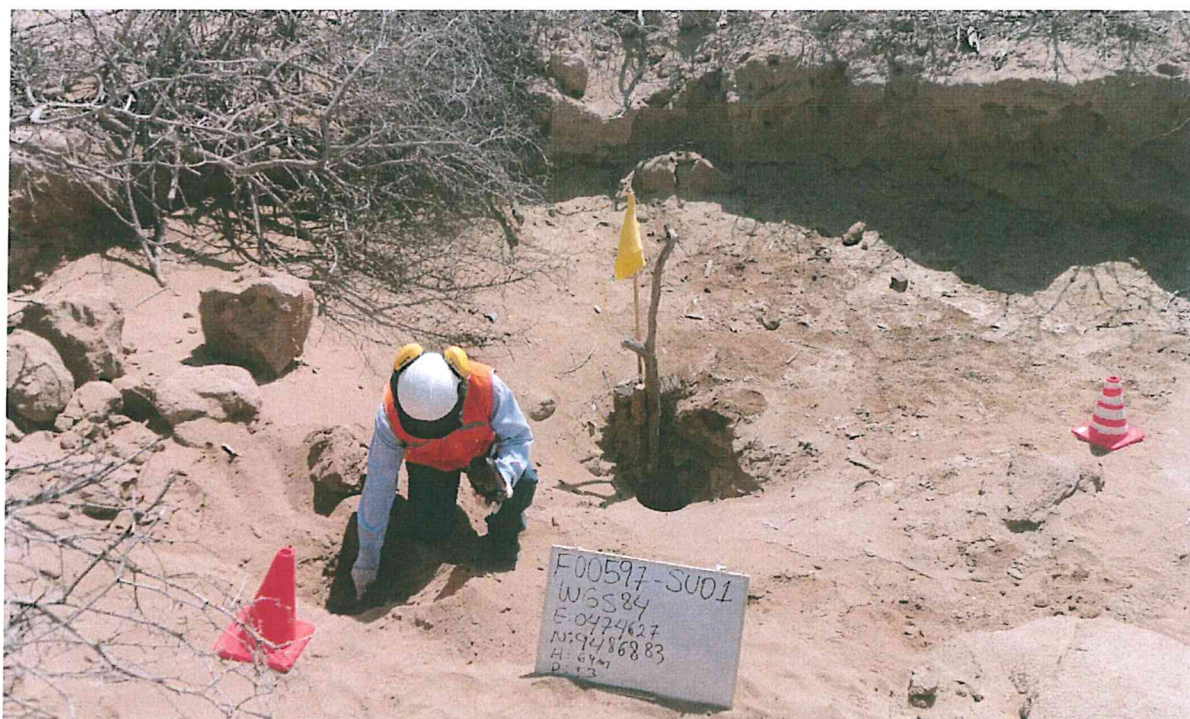
Fotografía N° 3. Toma de muestra de suelo en el punto F00597-SU01, ubicado a 2 m aproximadamente del Pozo T2833.
