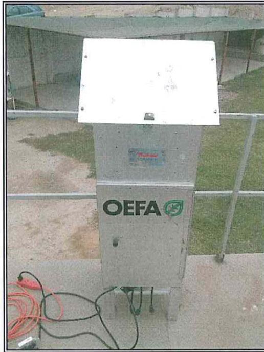
Fotografía N° 1: Estación de muestreo AI-CARP-01: Hi-Vol (PTS)
