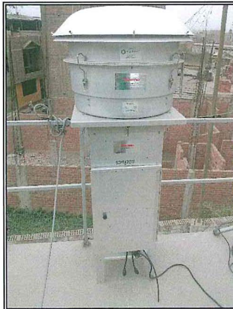
Fotografía N° 2: Estación de muestreo AI-CARP-01: Hi-Vol (PM-2,5)
