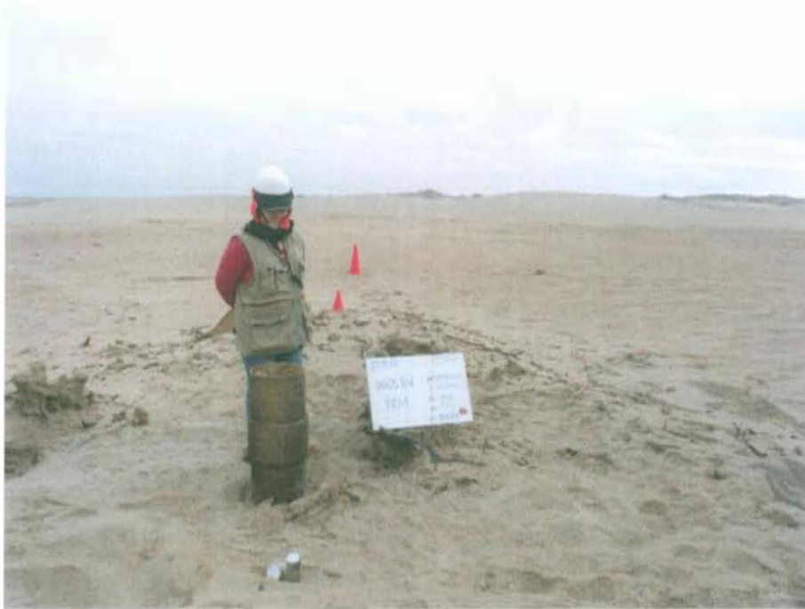
Fotografía N° 1. Pozo T2080 con extensión de 10 pulgadas que sobresale 0,7m sobre la superficie del suelo.
