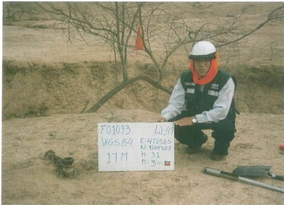
Fotografía N° 1. Vista de la ubicación georeferenciada del pozo donde se observa el casing abierto al ambiente y la válvula semienterrada en estado de corrosión
