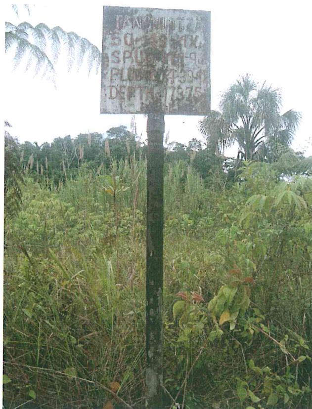
Fotografía N° 1. Pozo con código PERUPETRO QMC_50_43_1 y código Ficha OEFA F01471, se observa un tubo soldado a un letrero de identificación corroído expuesto a 2 m aproximadamente sobre la superficie del suelo.
