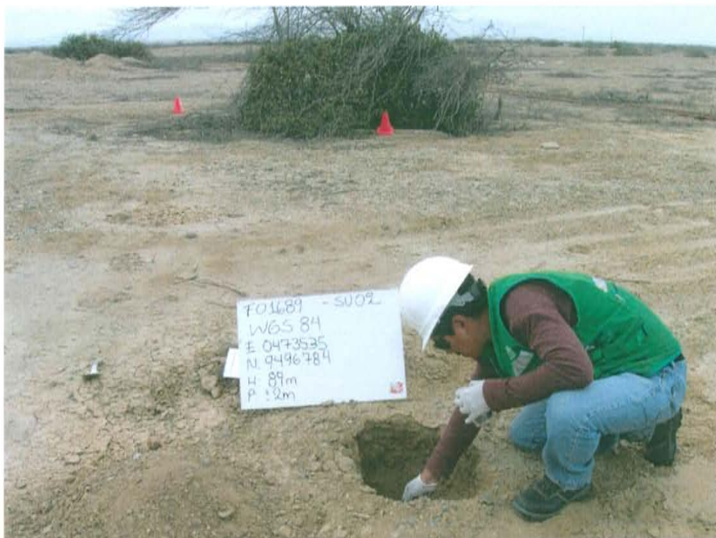
Fotografía N° 4. Toma de muestra de suelo en el punto F01689-SU02 ubicado a 9 m al oeste del Pozo T5318.
