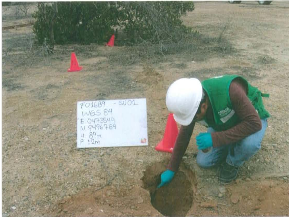
Fotografía N° 3. Toma de muestra de suelo en el punto F01689-SU01 ubicado a 7,8 m al noreste del Pozo T5318.
