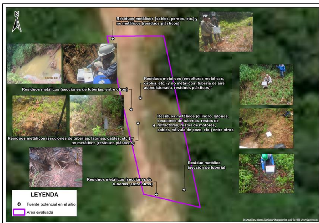
Figura 3.2. Fuentes potenciales de contaminación en el sitio S0557
