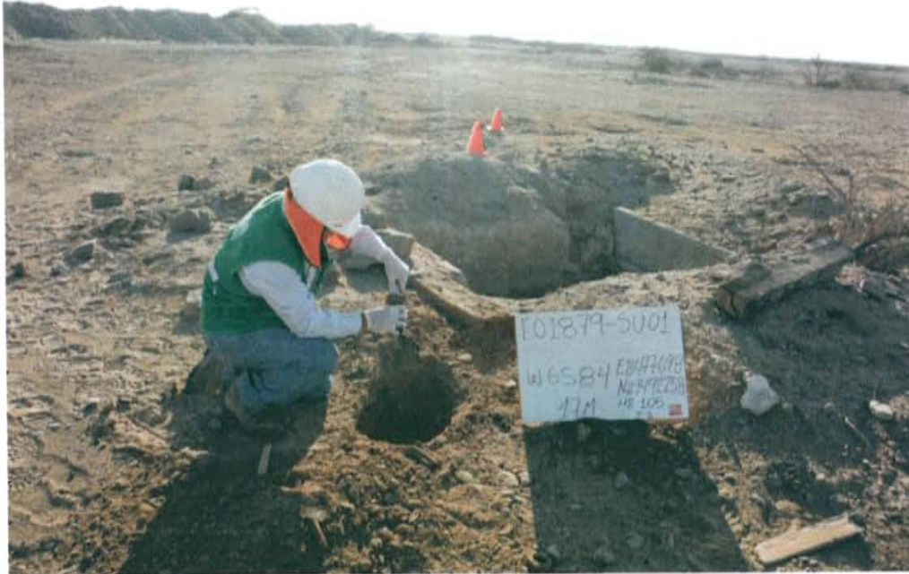
Fotografía N° 3. Recojo de muestra de suelo puntual a 3 m al este del pozo T5755.
