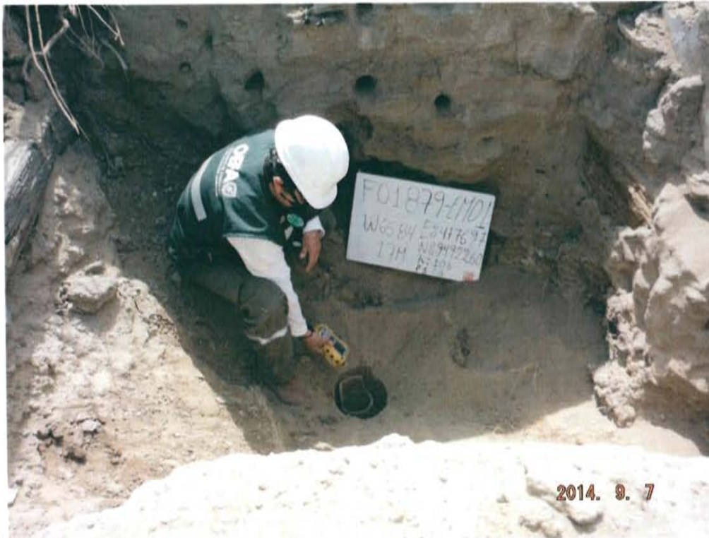
Fotografía N° 4. Medición de emisiones fugitivas en fuente de emisión, boca del pozo.
