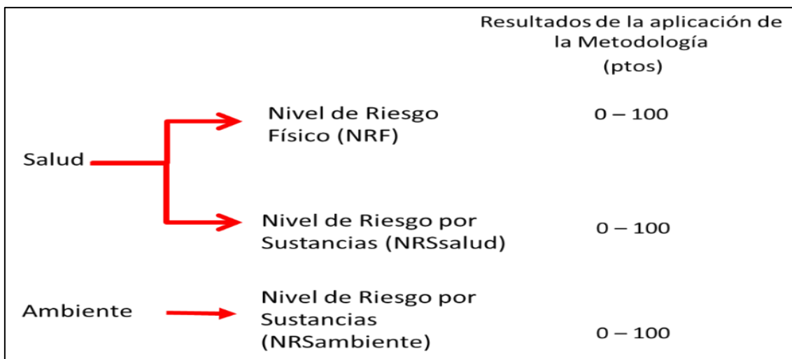
Figura 7.2. Indicadores de riesgos por presencia de peligros de tipo físico y por presencia de sustancias contaminantes
