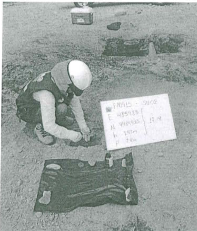
Fotografía N° 2. Toma de muestra en el punto F00915-SU02, ubicado a 3.40 m de distancia del casing del pozo T2334 a una profundidad de 0.20 m de la superficie del suelo.
