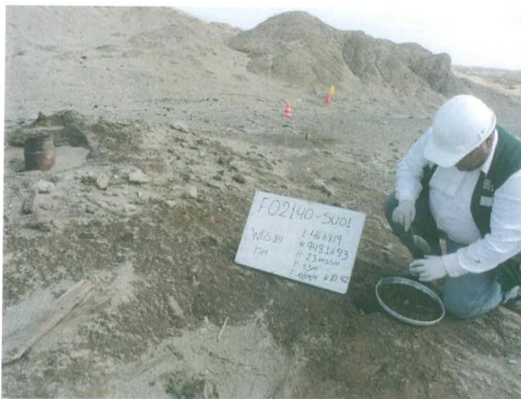
Fotografía N° 3. Toma de muestra de suelo en el punto F02140-SU01, ubicado aproximadamente a 3 m al este del Pozo T_626.
