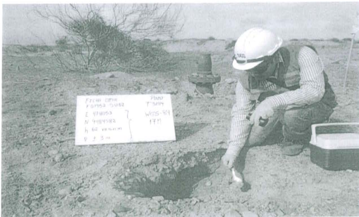
Fotografía N° 2. Toma de muestra de suelo en el punto F01952-SU02, ubicado a 3,5 m aproximadamente del Pozo.
