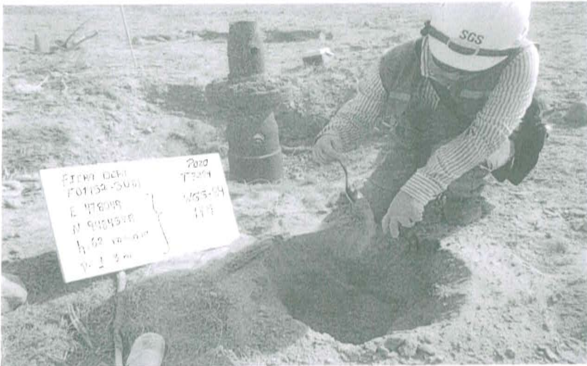
Fotografía N° 1. Toma de muestra de suelo en el punto F01952-SU01, ubicado a 2 m aproximadamente del Pozo.
