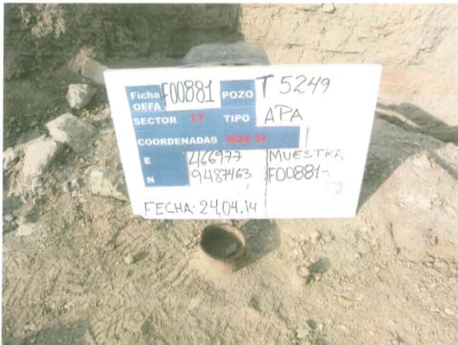
Fotografía N° 1. Vista de la ubicación georeferencial donde se observa el pozo con el casing abierto al ambiente en estado de deterioro dentro de un hoyo.
