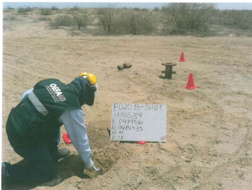
Fotografía N° 3. Toma de muestra de suelo en el punto F02013-SU01, ubicado a 3 m aproximadamente del Pozo T2992.
