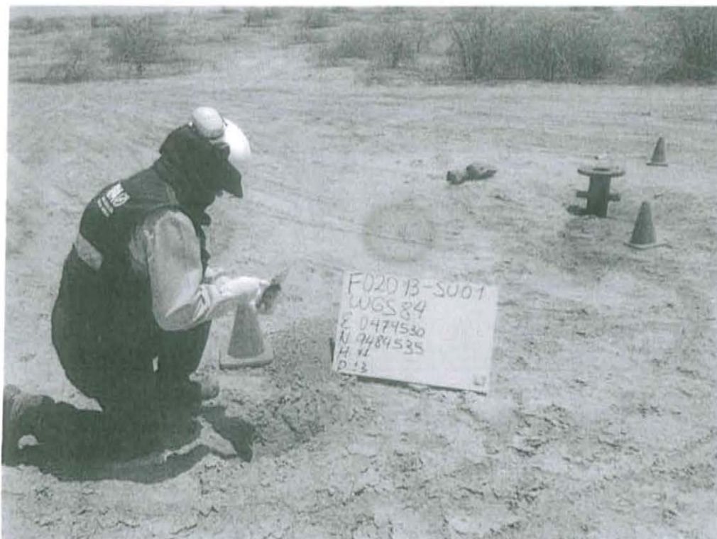
Fotografía N° 1. Toma de muestra de suelo en el punto F02013-SU01, ubicado a 3 m aproximadamente del Pozo T2992.
