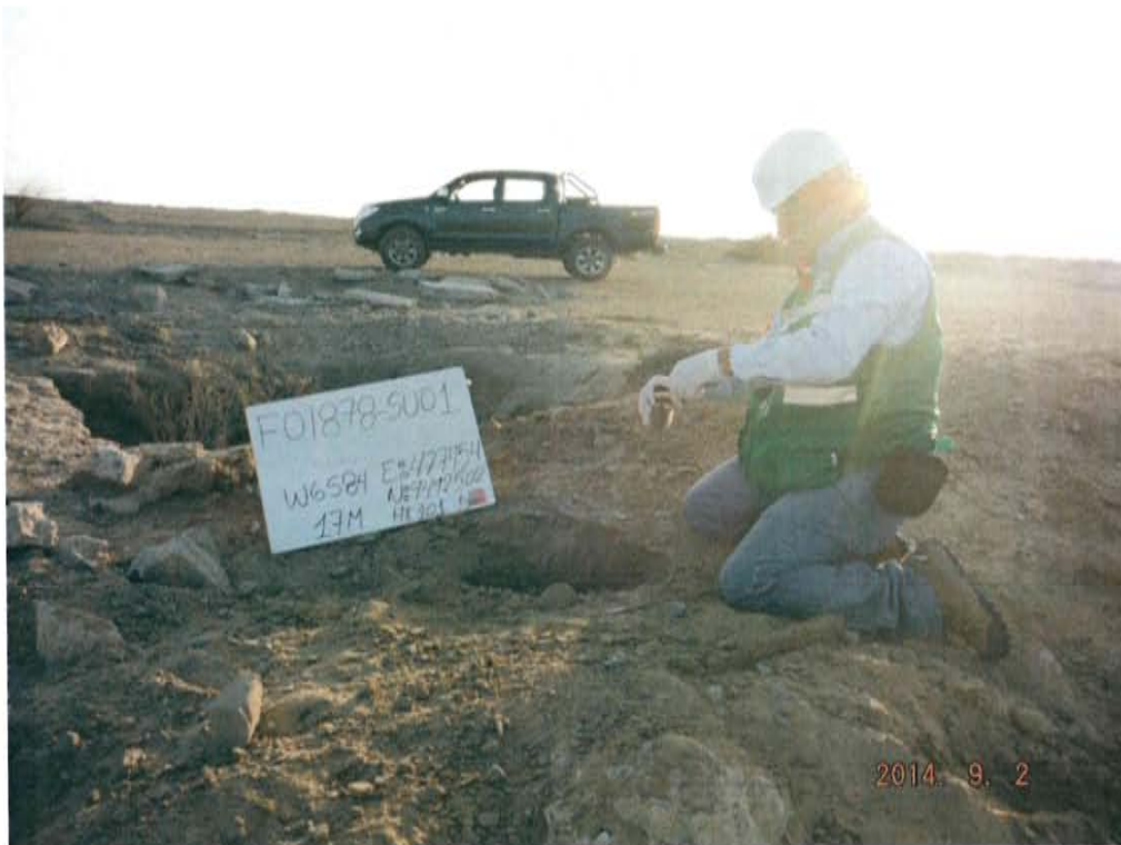
Fotografía N° 3. Toma de muestra de suelo impregnado con hidrocarburos.
