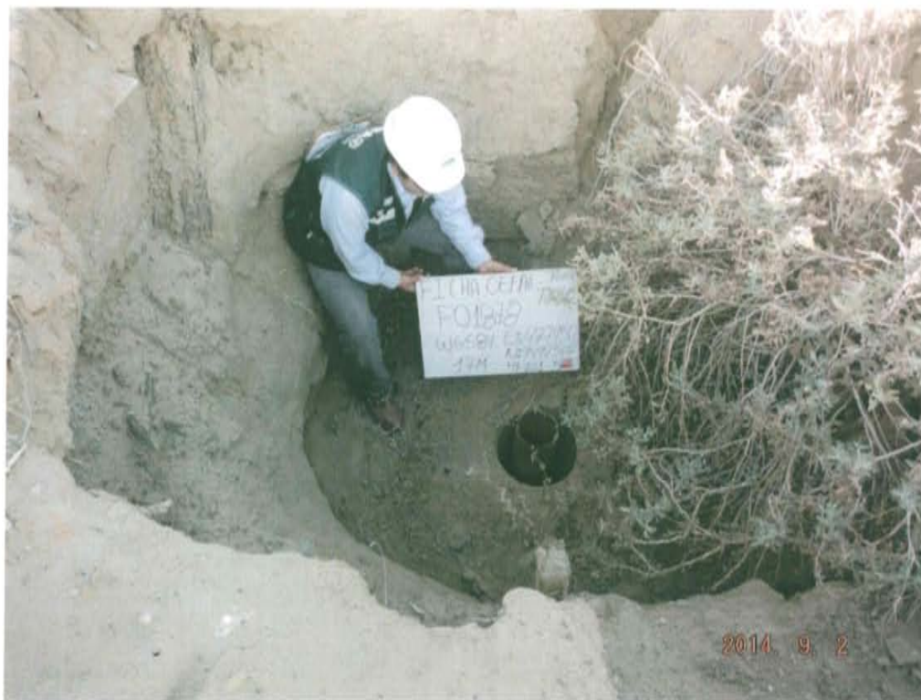
Fotografía N° 1. Pozo inactivo con código PERUPETRO T3740 que se encuentra dentro de hoyo, no posee cabezal ni válvulas solo se observa dos casing concéntricos abierto al ambiente.
