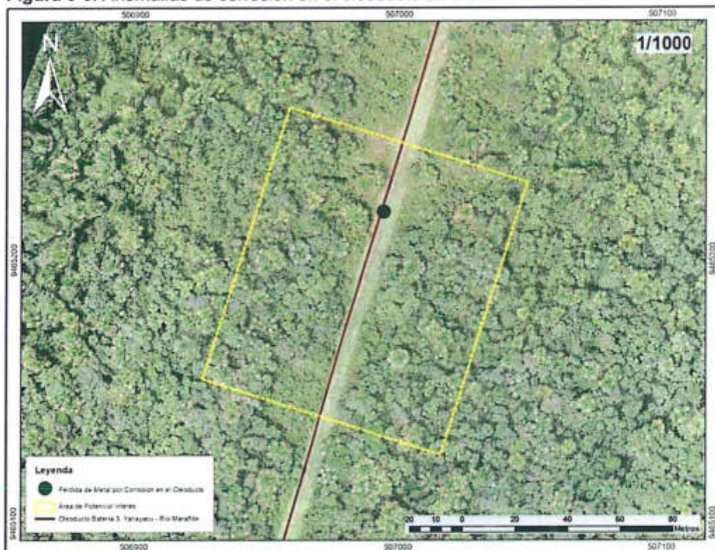
Figura 3-3. Anomalías de corrosión en el oleoducto en el área del sitio S0024
