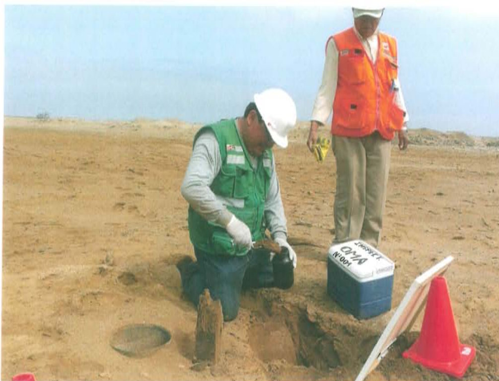
Fotografía N° 3. Primer punto de muestreo del pozo con código PERUPETRO T1188 a 0,7 m de distancia desde el pozo.
