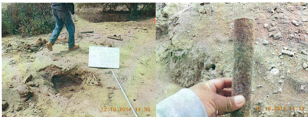
Fotografía N° 3. Se encontraron residuos de madera con presencia de hidrocarburos hallados en el área donde se encuentra enterrado el pozo T3451.
