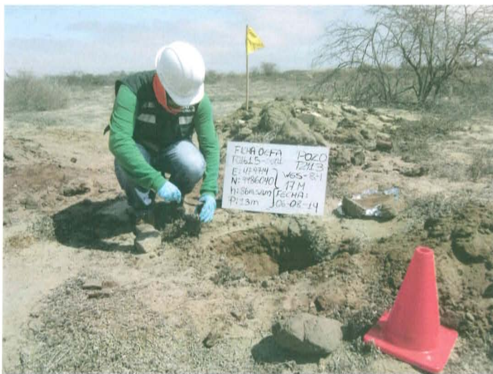
Fotografía N° 3. Toma de muestra de suelo en el punto F01615-SU01, ubicado a 2,5 m del Pozo T2113.
