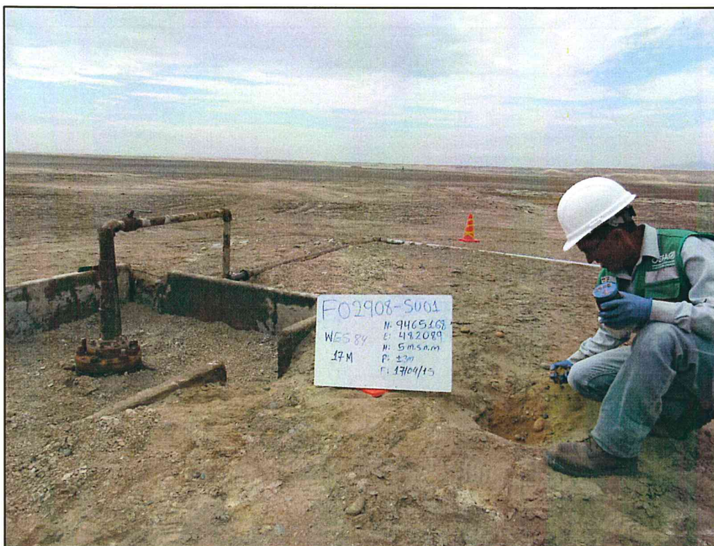
Fotografía N° 3. Toma de muestra de suelo en el punto F02908-SU01, ubicado a 2,5 m al este del pozo con código PERUPETRO T5967.
