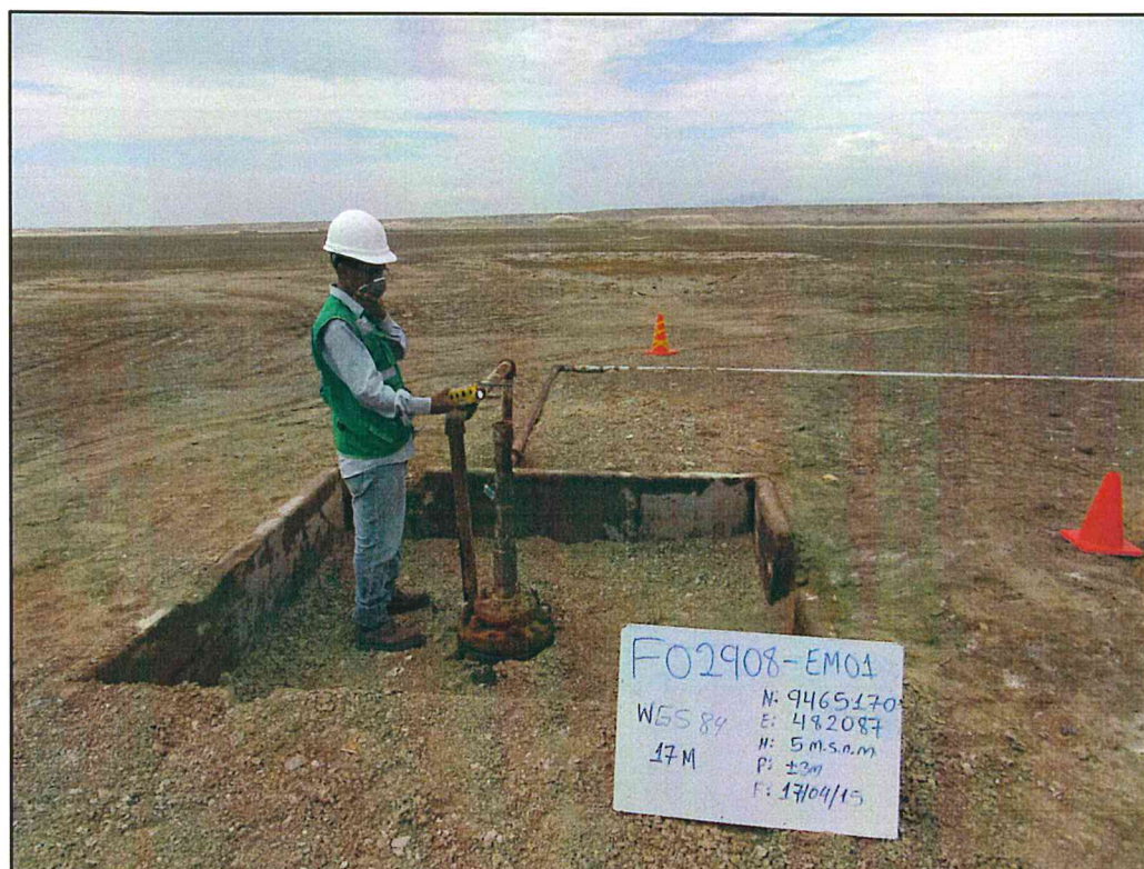
Fotografía N° 4. Medición de emisiones gaseosas fugitivas en boca de pozo con código PERUPETRO T5967.
