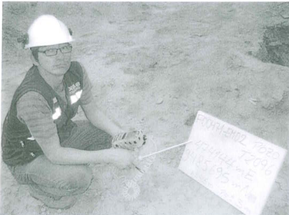
Fotografía N° 2. Medición en el punto F00471-EM02, ubicado a 3 m del Pozo T2096 a sotavento
