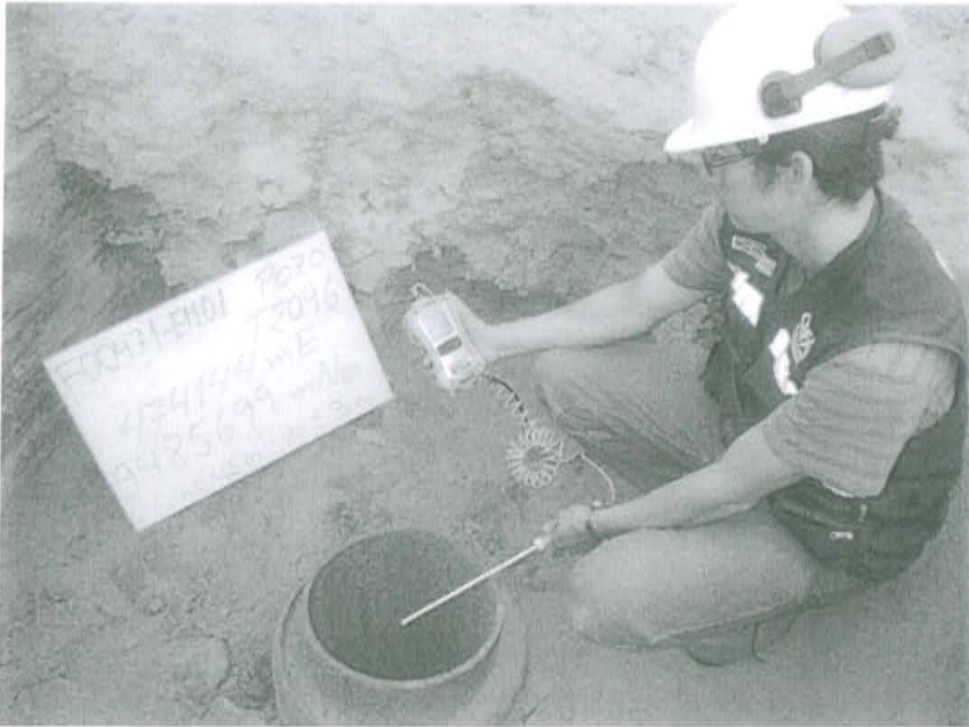
Fotografía N° 1. Medición en el punto F00471-EM01, ubicado en la fuente de emisión en boca de Pozo T2096.
