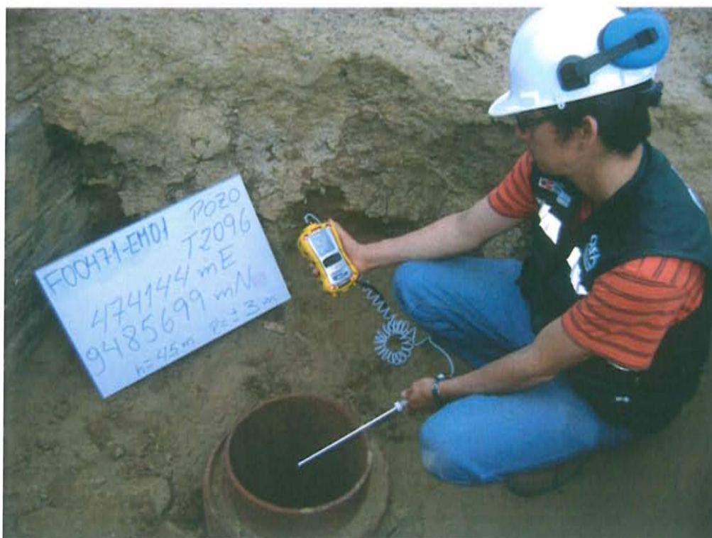
Fotografía N° 4. Medición en el punto F00471-EM01, ubicado en la fuente de emisión en boca del Pozo T2096.
