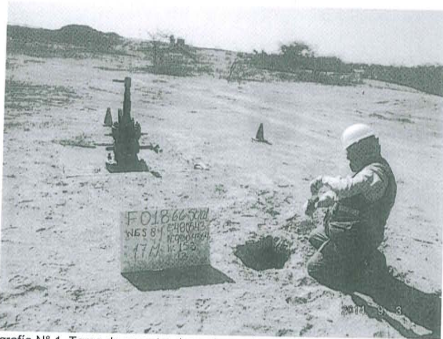
Fotografía N° 1. Toma de muestra de suelo en el punto F01866-SU01, ubicado a 3 m aproximadamente del Pozo T4399.
