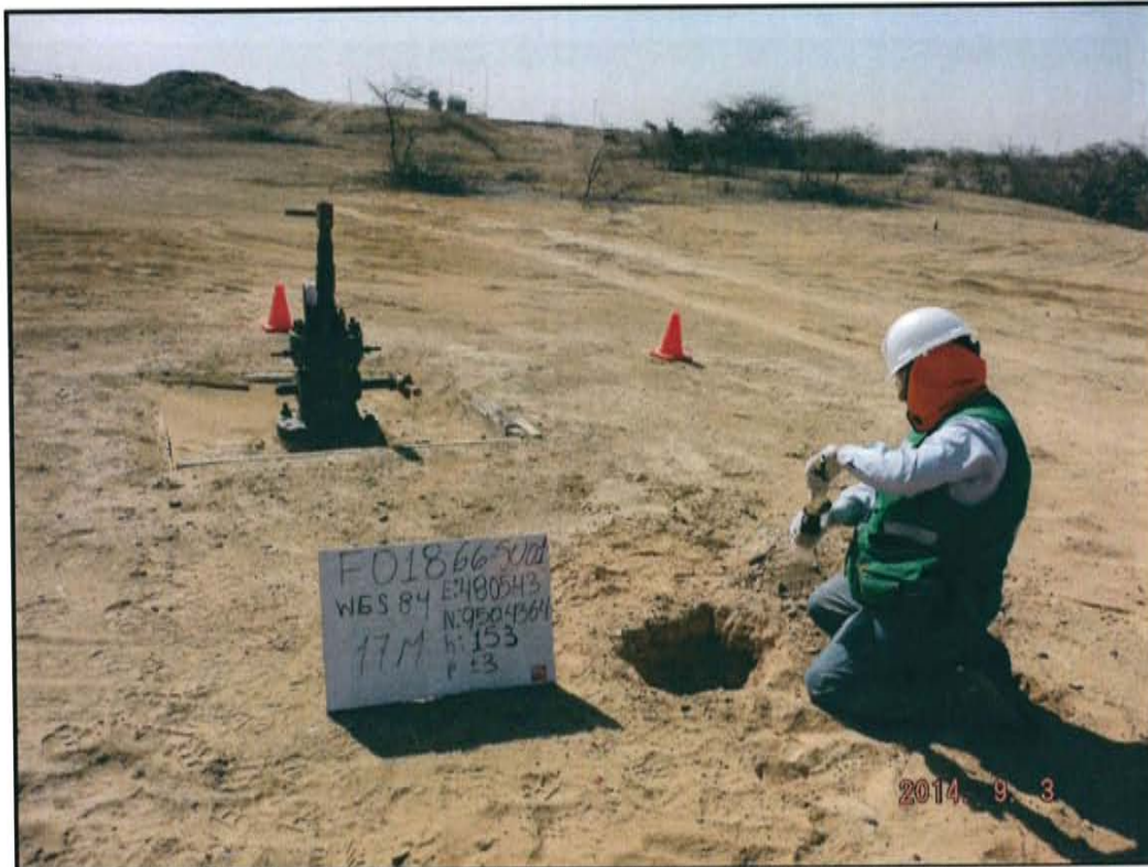
Fotografía N° 3. Muestra de suelo tomada aproximadamente a 3 m al este del pozo.
