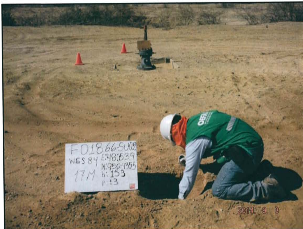
Fotografía N° 4. Muestra de suelo tomada aproximadamente a 6 m al este del pozo.
