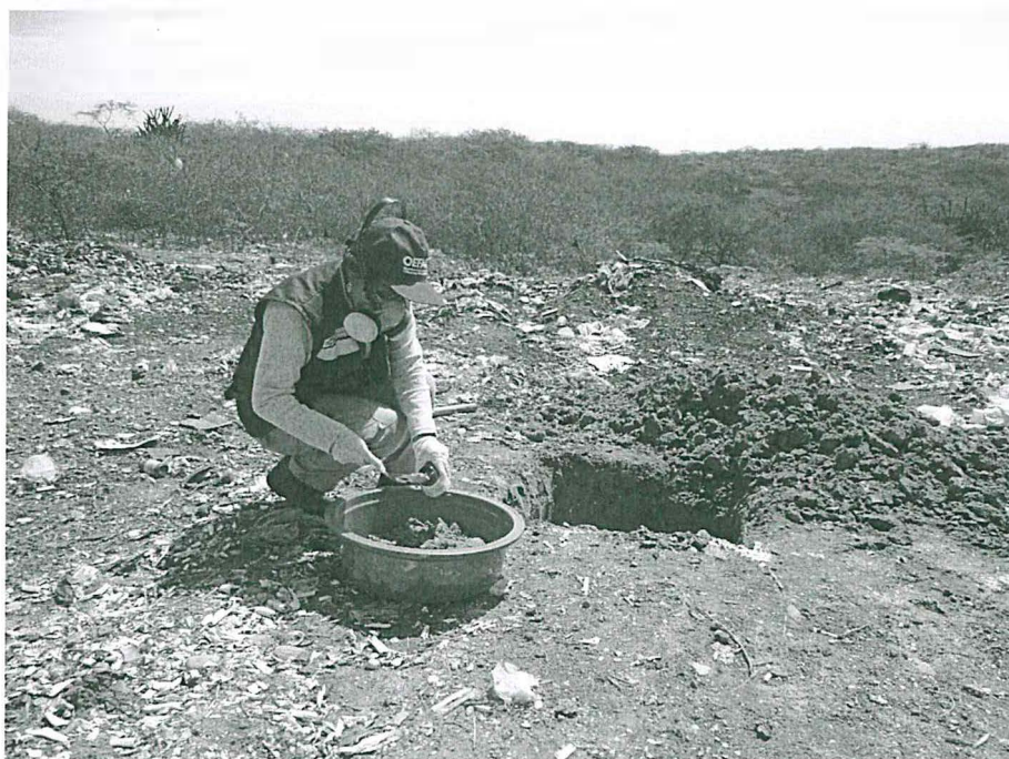
Fotografía 8. Colecta de muestra de suelo para análisis de orgánicos. Punto de muestreo SU – E7, calicata de 80 cm x 80 cm con 60 cm de profundidad. Botadero de la Municipalidad de la ciudad de Tumbes, 15-05-2014
