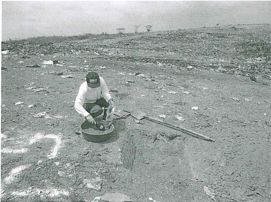
Fotografía 7. Colecta de muestra de suelo para análisis de metales. Punto de muestreo SU – E5, calicata de 80 cm x 80 cm con 30 cm de profundidad. Botadero de la Municipalidad de la ciudad de Tumbes, 14-05-2014
