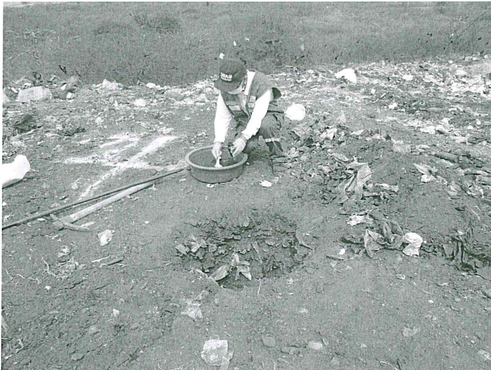
Fotografía 4. Punto de muestreo SU – E3, suelo de relleno con presencia de residuos sólidos, calicata de 80 cm x 80 cm con 65 cm de profundidad. Botadero de la Municipalidad de la ciudad de Tumbes, 14-05-2014.
