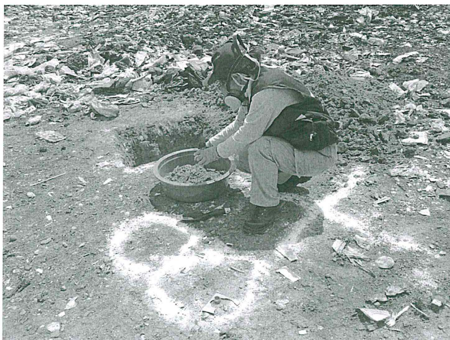
Fotografía 9. Colecta de muestra de suelo para análisis de orgánicos. Punto de muestreo SU – E8, calicata de 80 cm x 80 cm con 60 cm de profundidad. Botadero de la Municipalidad de la ciudad de Tumbes, 15-05-2014
