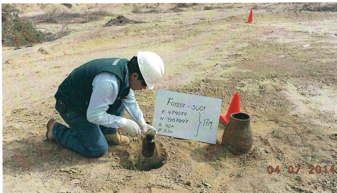
Fotografía N° 3. Toma de muestra de suelo en el punto F01357-SU01, ubicado a 0.7 m aproximadamente del Pozo T 2635.
