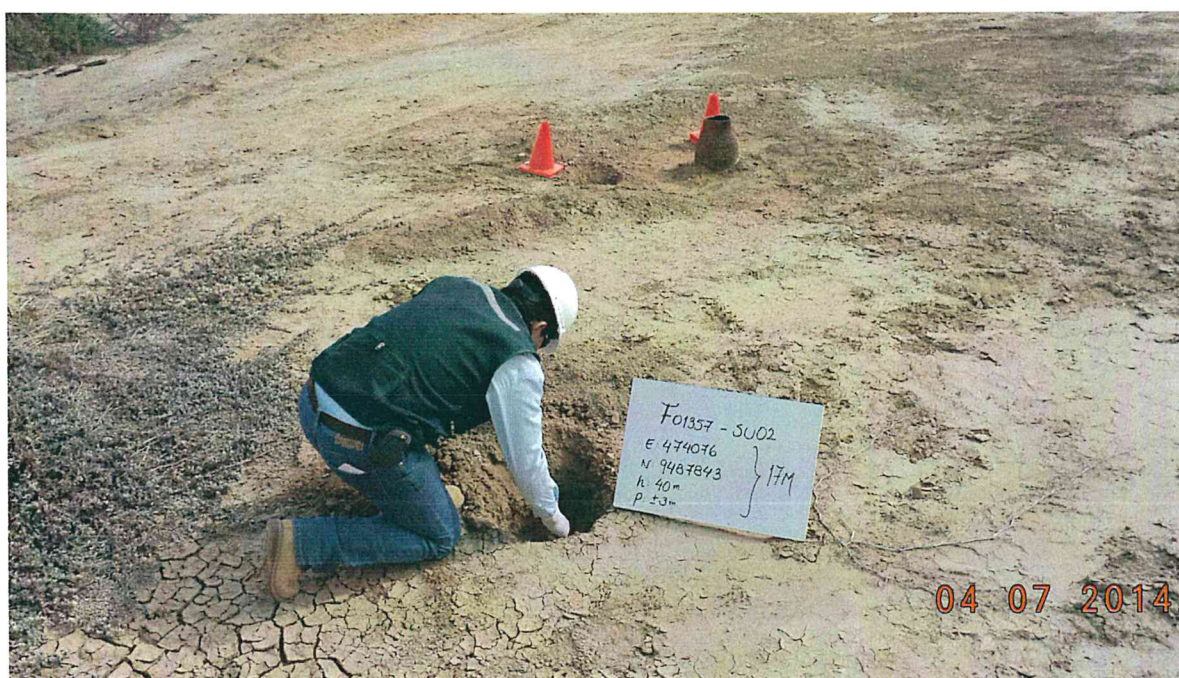
Fotografía N° 4. Toma de muestra de suelo en el punto F01357-SU02, ubicado a 3.6 m aproximadamente del Pozo T 2635.
