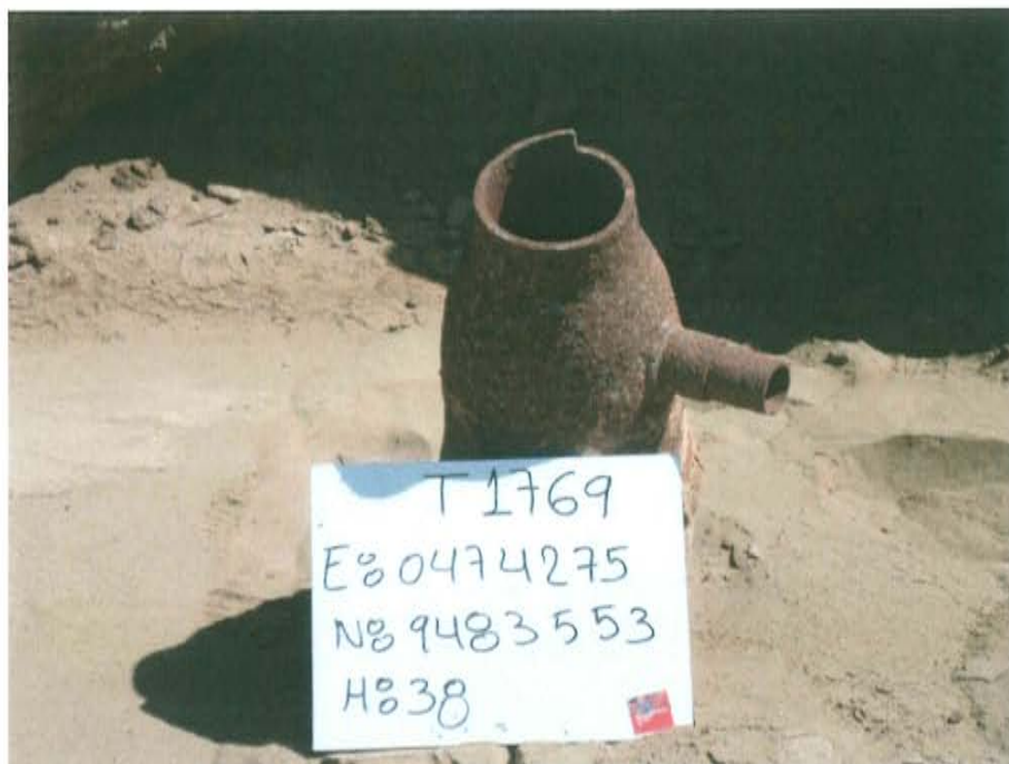
Fotografía N° 1. Pozo inactivo con casing ubicado dentro de una excavación de 1,30 m de profundidad.
