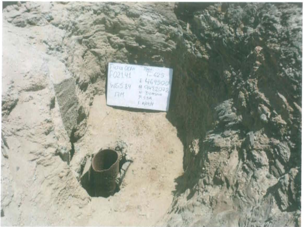
Fotografía N° 1. Se observa casing corroído que sobresale del interior de un hoyo, por lo que se considera un pozo abierto al ambiente.
