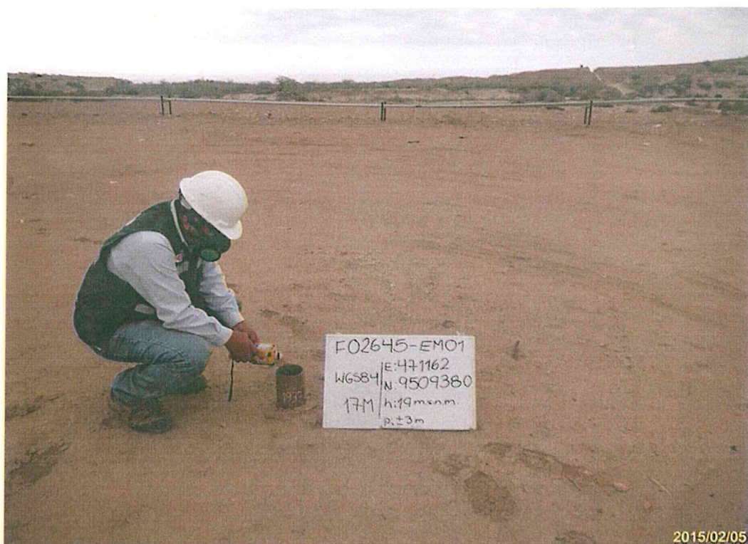
Fotografía N° 3. Medición de emisiones gaseosas fugitivas en la fuente de emisión, boca del pozo, con una duración de 15 minutos.
