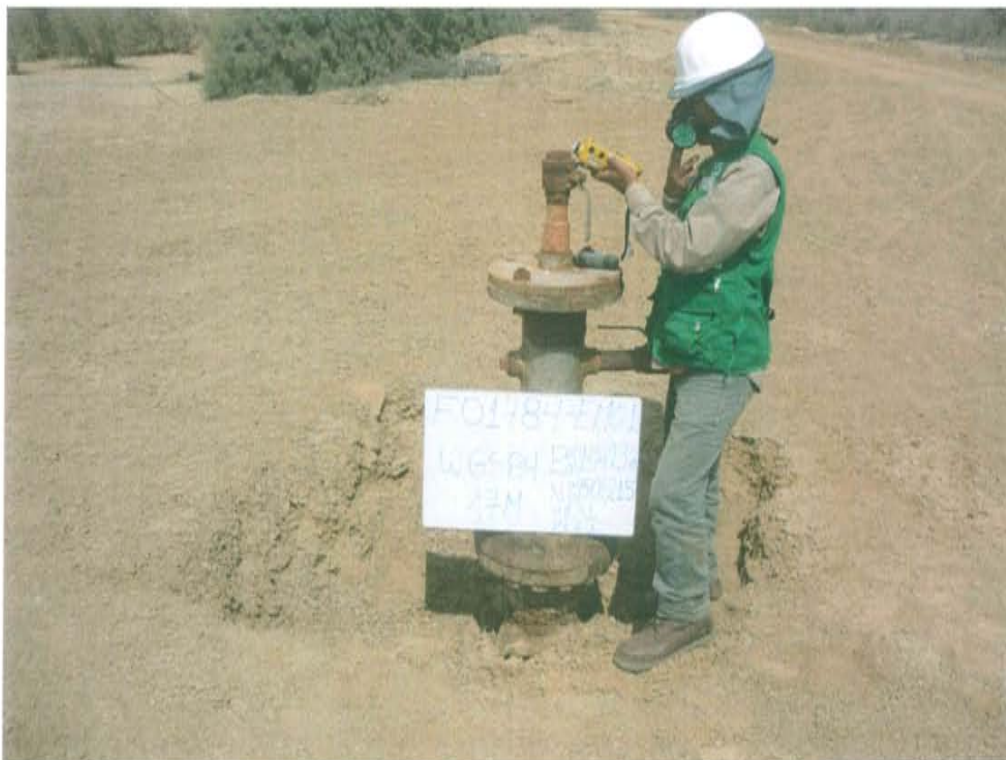
Fotografía N° 4. Medición en el punto F01784-EM01, ubicado en la fuente de emisión en boca del Pozo T3736.
