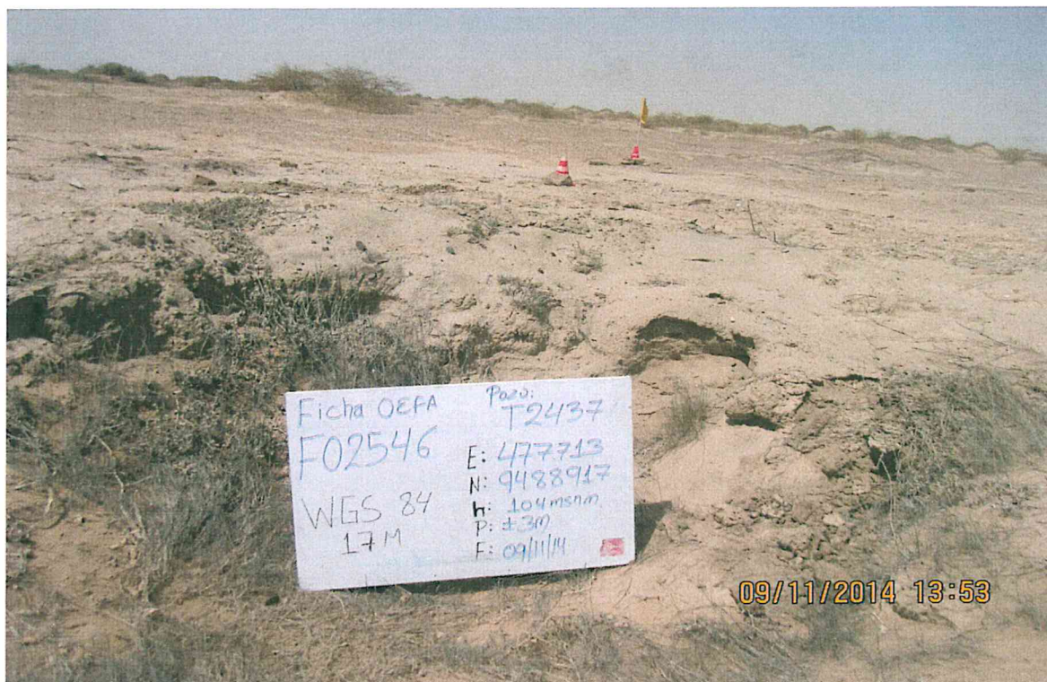
Fotografía N° 1. Pozo no ubicado a nivel superficial, no se visualizó el terraplén ni el acceso vehicular hacia el pozo. Se observó que los alrededores a la coordenada de posible ubicación presentan gran cantidad de arena acumulada. Se realizó excavaciones encontrando suelo con presencia de hidrocarburos
