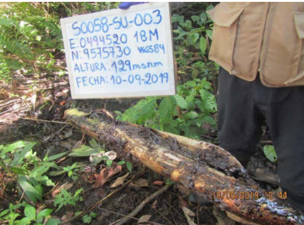
El suelo saturado presenta abundante materia orgánica mezclado con hidrocarburos, siendo evidente el cambio de olor y color en el suelo.
