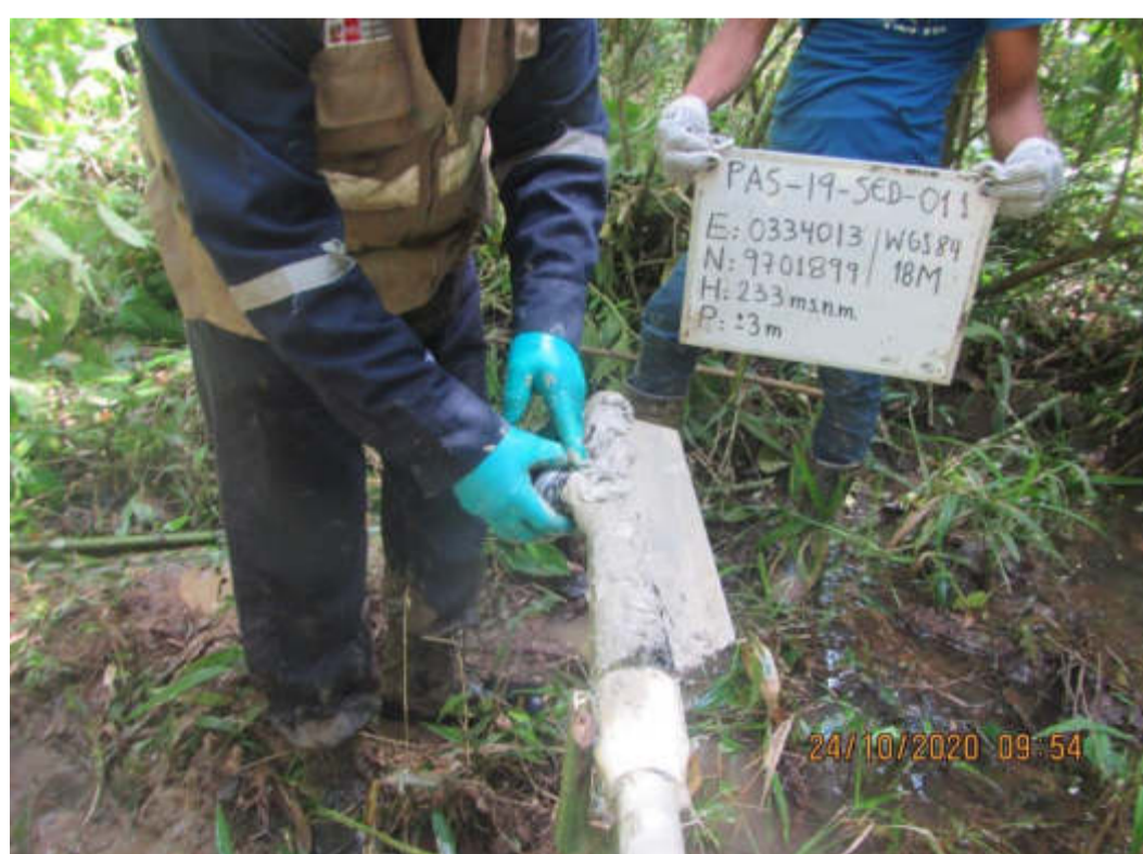
Muestreo de sedimento en el punto de muestreo PAS-19-SED-011, donde se reportó TPH en concentraciones superiores a la norma de uso referencial.
