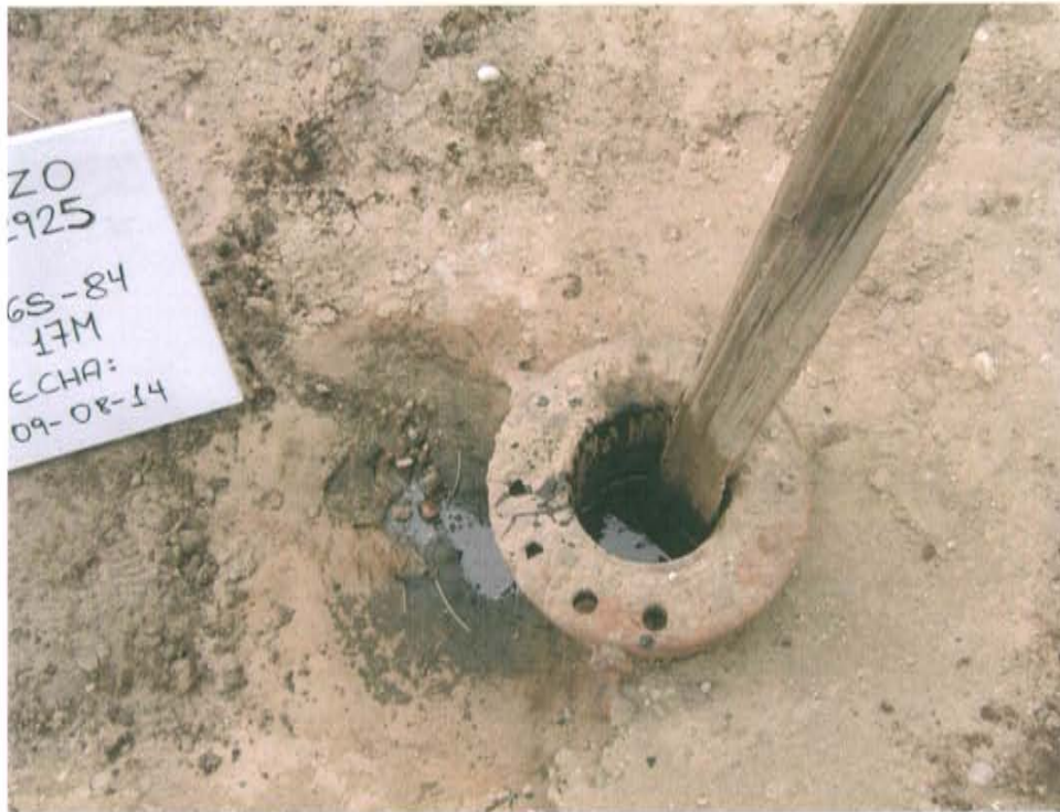
Fotografía N° 3. Se observa afloramiento de fluidos del Pozo T2925, el cual se encuentra impactando el suelo.
