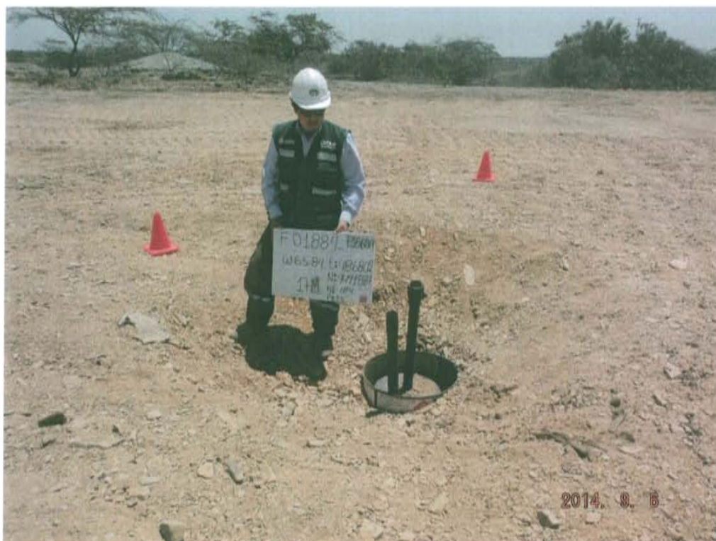
Fotografía N° 1. Pozo inactivo, sin cabezal presenta cilindro alrededor del pozo en su interior se observa hidrocarburo aproximadamente 0.8 m por debajo de la superficie del suelo.
