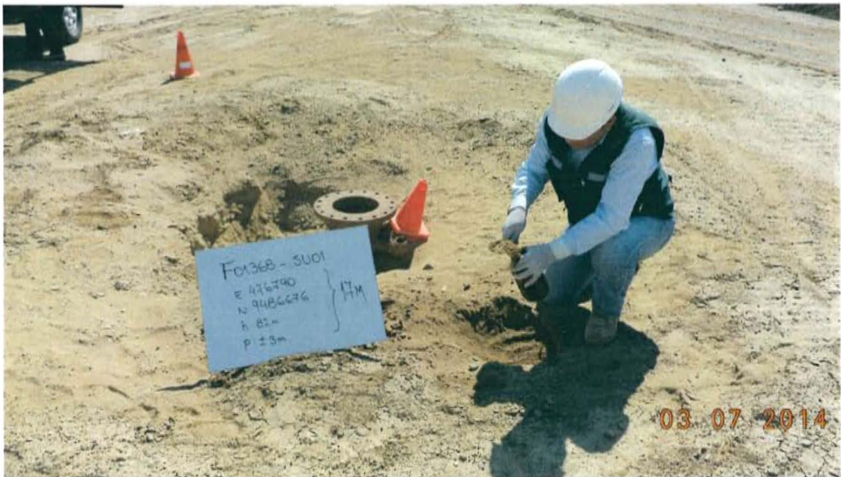
Fotografía N° 3. Toma de muestra de suelo en el punto F01368-SU01, ubicado a 1,2 m aproximadamente del Pozo T2398.
