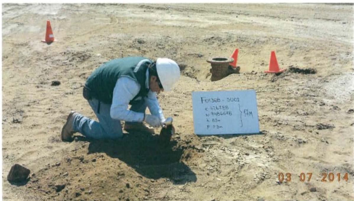
Fotografía N° 4. Toma de muestra de suelo en el punto F01368-SU02, ubicado a 3,2 m aproximadamente del Pozo T2398.
