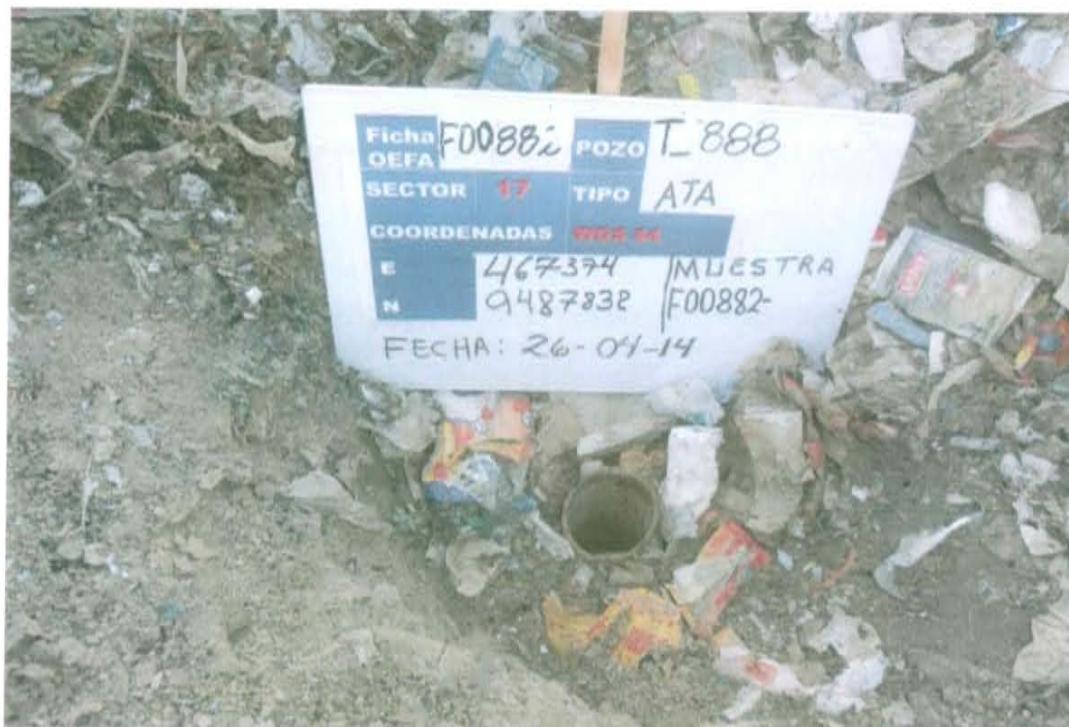
Fotografía N° 1. Vista de la ubicación georeferencial donde se observa el pozo con el casing cortado expuesto al ambiente dentro de un hoyo superficial.
