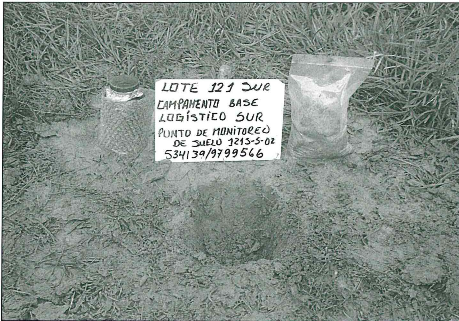
Fotografía N°01: Punto de Monitoreo 121S-S-02
