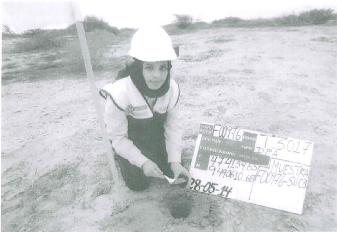
Fotografía N° 3. Toma de muestra de suelo en el punto F00976-SU03, ubicado a 38,10 m de distancia del Casing, Pozo T3017.
