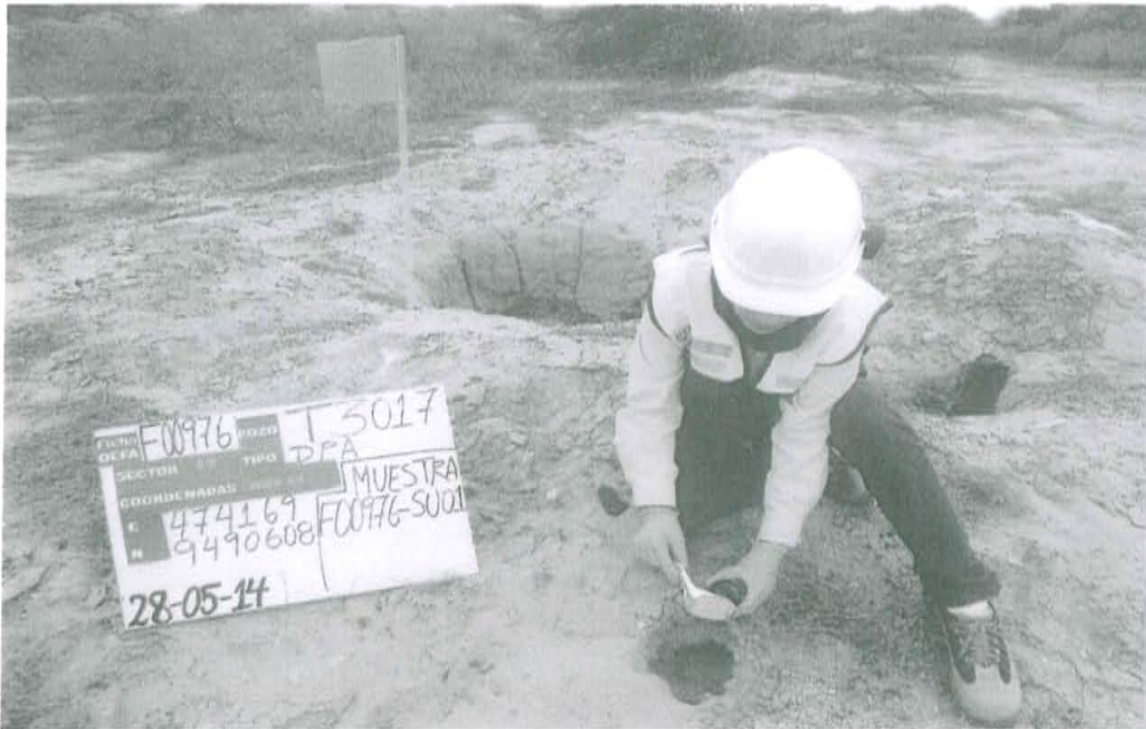
Fotografía N° 1. Toma de muestra de suelo en el punto F00976-SU01, ubicado a 2,40 m de distancia del Casing, Pozo T3017.
